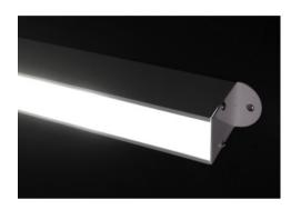
Коэффициент пульсации не более, % 1 Температура свечения, К 4000-5000 Коэффициент мощности, PF> 0,9 Тип крепления (тип монтажа) Накладной Класс защиты, ІР 40 Гарантия, лет 1 год Наличие вторичной оптики Нет Тип светодиодов NICHIA (Япония) Габариты, тт L1550 B50 H65 Производитель Россия Срок службы светильника, лет 15 Угол свечения, ° 120 Покрытие Полимерное (цвет белый) Световой поток, Lm 7560±15% Сплав алюминия Материал корпуса Напряжение питания, V 220±6%
